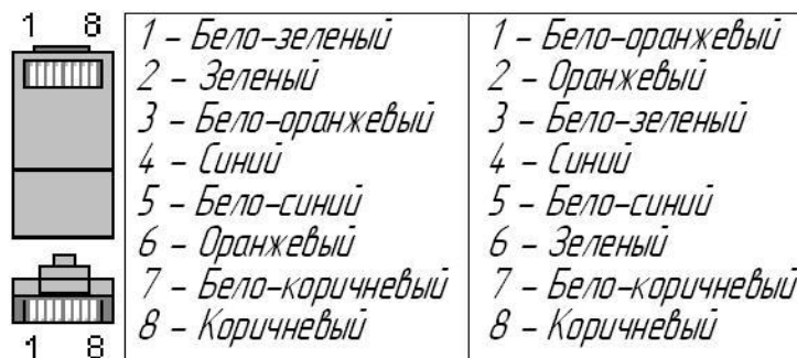
Рисунок 4 – Схема разделки кабеля подключения изделия к сети 10BaseT/100BaseTX Ethernet.
