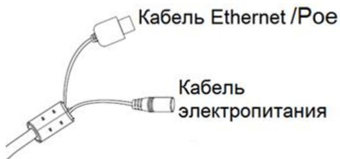
Рисунок 4 – Кабели подключения IP-видеокамеры SDP-850
