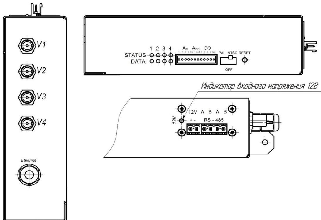
V1-V4 – Разъемы для подключения аналоговых видеокамер
