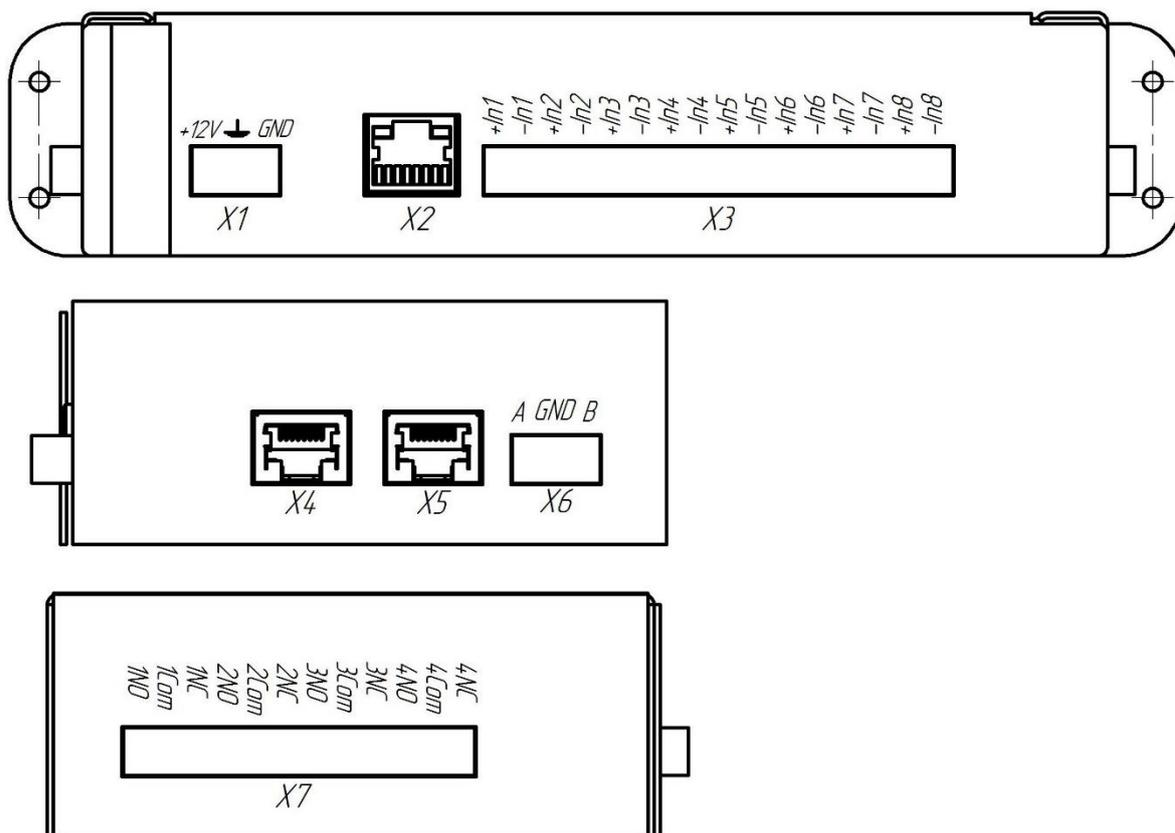
X1 – Разъем для подключения напряжения электропитания постоянного тока 12В
